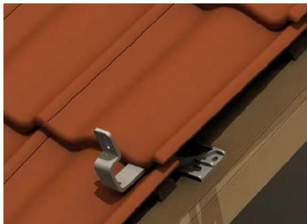
Replacer ensuite la tuile supérieure en contrôlant son bon positionnement et sa bonne mise en place.
