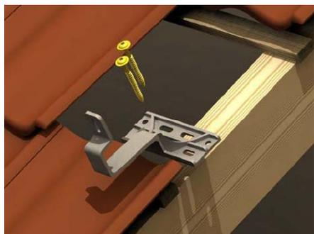
Les pattes de fixation se montent sur le chevron (ou sur la lambourde verticale fixée sur le chevron).
