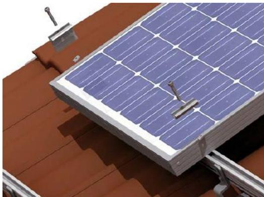
Positionnez le panneau sur les profilés et fixez chaque panneau au moyen des pinces fournies dans le kit. Les pinces terminales se montent à l'extrême gauche et à l'extrême droite de la ligne de panneau. Les pinces intermédiaires fixent les panneaux deux à deux.
